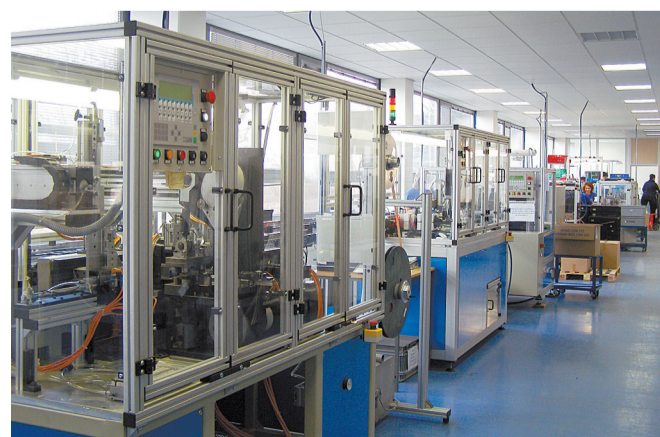
MONTÁŽE. Finální výrobky montujeme na plně automatických linkách, poloautomatických zařízeních i ručně. Součástí automatických linek je kontrola pomocí kamer. Další výrobky se kontrolují pomocí kontrolních automatů a speciálních zařízení.
